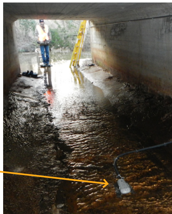
Débitmètre à profil Doppler acoustique SonTek IQ pour canal ouvert/conduite non pleine installé dans un canal d'eaux pluviales standard.
